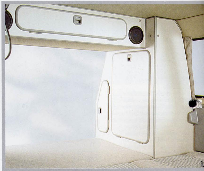
1. Kleiderschrank und Dachstaukasten im Fahrzeugheck
